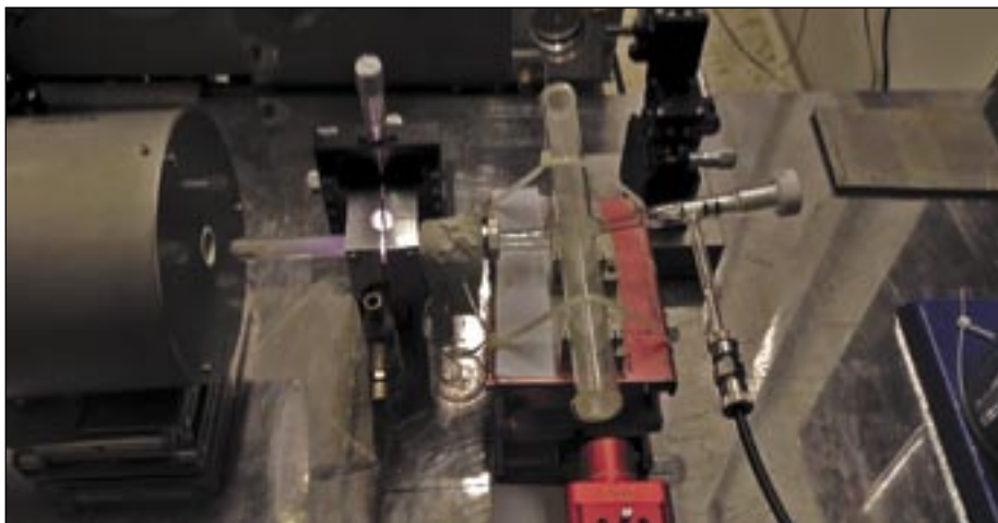
Fotografie experimentálního uspořádání pro měření vysoce rozlišitelných absorpčních spekter D_2O odpařené s povrchu oxidických minerálů po ozáření mikrovlnným výbojem ( D^+ ionty)
