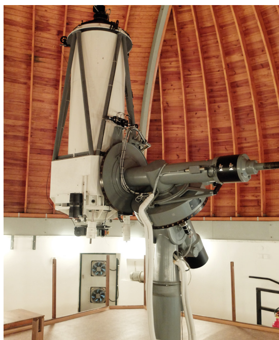
Obr. 5 Výsledná ohnisková vzdálenost 2 675 mm je s tzv. komakorektorem, velikost pixelu je 6,8 \mu\text{m} . Foto: J. Žďárská
