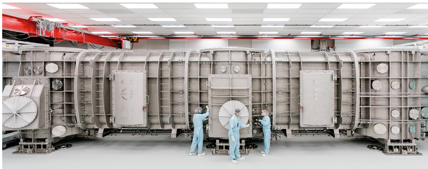
Po dokončení obřích kompresorů pulzů, který je při své délce 18 m a výšce 4 m jedním z největších zařízení tohoto druhu na světě, bude možné na laseru L4 ATON dosáhnout špičkového výkonu 10 PW. Foto: archiv ELI Beamlines
