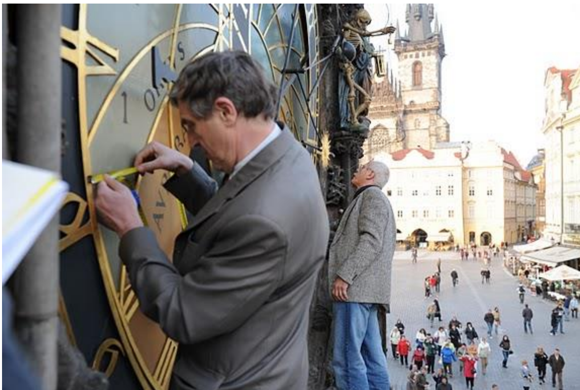
Při proměřování velikostí kružnic na astronomickém ciferníku Staroměstského orloje jsem zjistil, že některé kružnice jsou nepřesně zakresleny. Např. střed pražského horizontu se liší o 6 cm od teoretické hodnoty (2010).
